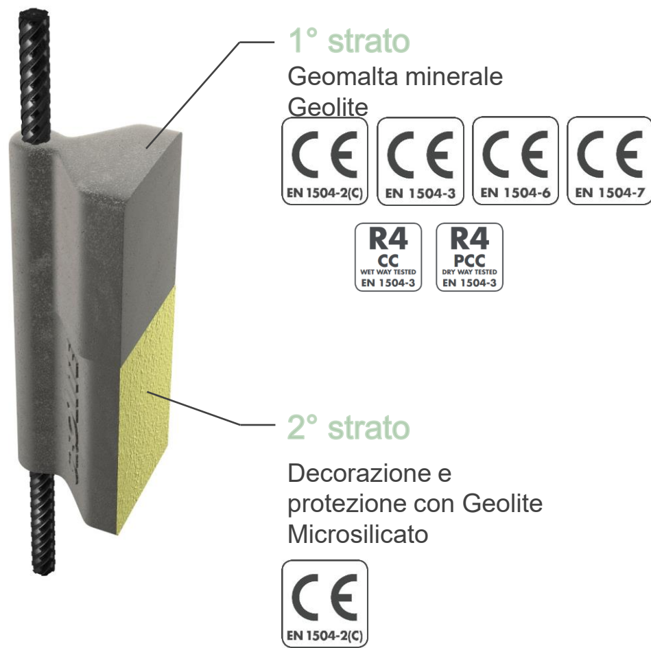
Intervento monolitico con Geolite
