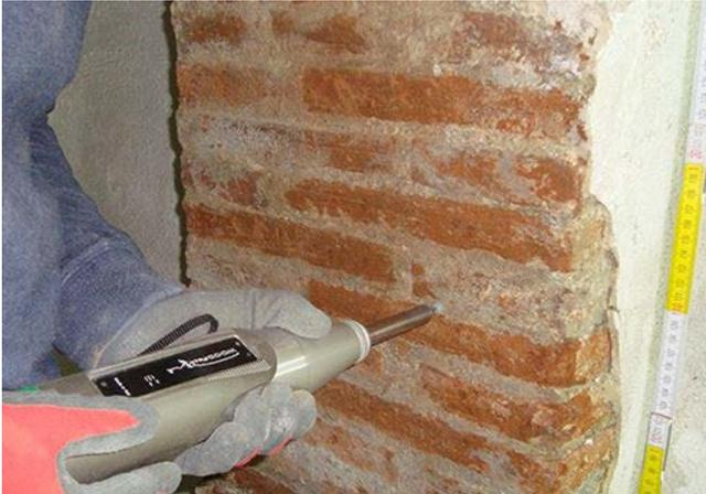
Le indagini sulla resistenza delle malte rivestono una notevole importanza perché **permettono di stimare le caratteristiche meccaniche di una muratura.**
