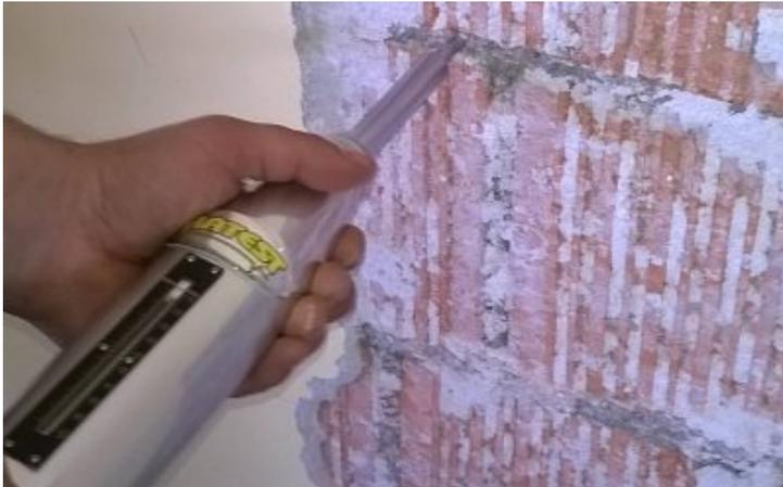
La **prova sclerometrica** è una prova non distruttiva che permette di determinare le caratteristiche di resistenza superficiale di materiali come il calcestruzzo e la **muratura**.
