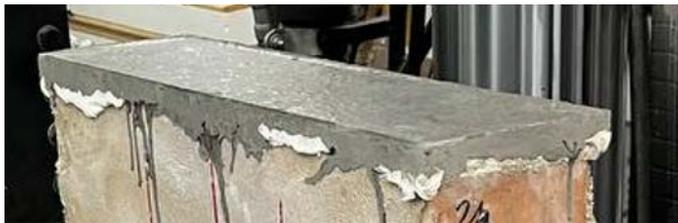
Sono stati applicati due strati di malta per regolarizzare le sezioni a contatto con la macchina di prova.
