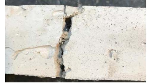
Intonaci sismo-resistenti con fibre di canapa
